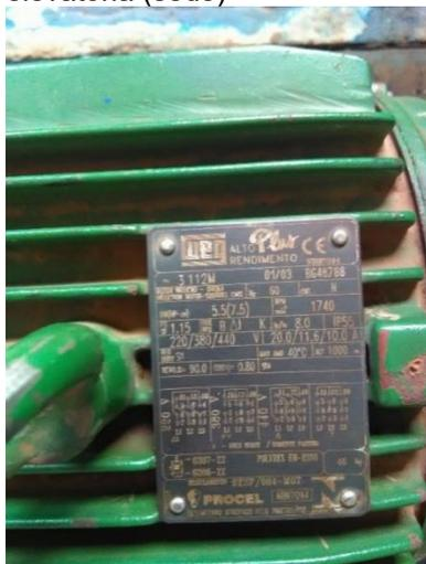
Foto 39 – Placa identificação da bomba da elevatória (sede)
