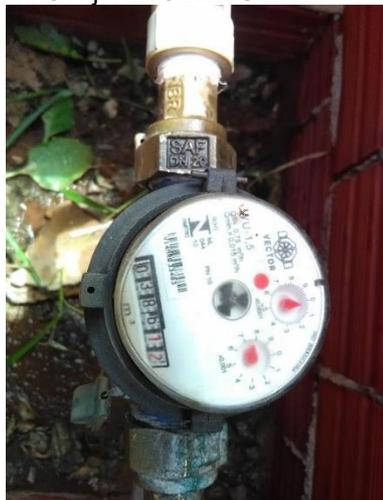
Foto 55 – Medição de pressão na rede: Hidrômetro campo de futebol suíço no Conjunto Oscar Cotrin (P=48 mca)
